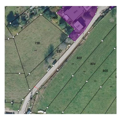
Im hinteren Bereich ist die Fahrbahn nach Plan etwa 5,3m breit; hier verbleiben 3,6m befestigte Fahrbahn. Hier ist auch die Stelle mit dem beschädigten Grünstreifen und vermutlich auch der darunterliegenden Drainage (siehe folgende Bilder).
